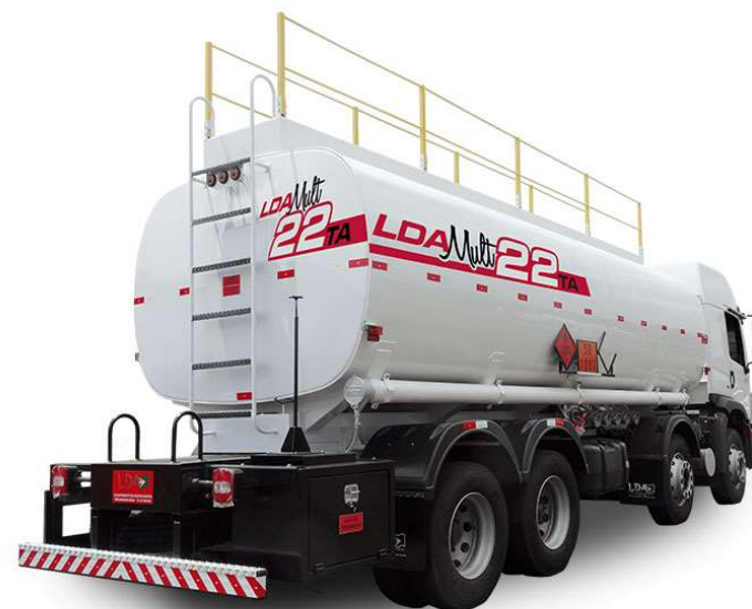
Caminhão tanque com guarda corpo
